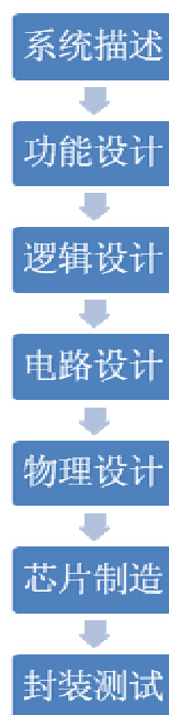
图表 4 传统 VLSI 的设计流程
